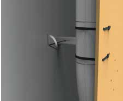
7. Particolare del fissaggio dei perni a parete.
